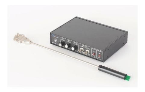
Mr.Squid®は 1992 年以来、研究者の物理実験の標準的なデモンストレーションシステムとして採用されています。 Mr.Squid® は、高温超伝導体 (HTS) 技術に基づいた完全な超伝導量子干渉デバイス (SQUID) システムです。 Mr. SQUID® システムは、取り外し可能な磁気シールド付きの頑丈なプローブに取り付けられた HTS 薄膜 SQUID チップ、高度な電子制御ボックス、および真空デュワー瓶で構成されています。
